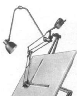
Tecnigrafi da tavolo: a sinistra, tecnigrafo a molle e contrappeso degli anni '50; sopra, tecnigrafo a rotaia degli anni '70.
