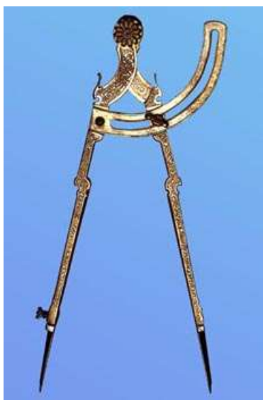
Compasso ad aletta in ottone dorato e punte d'acciaio (1604).
