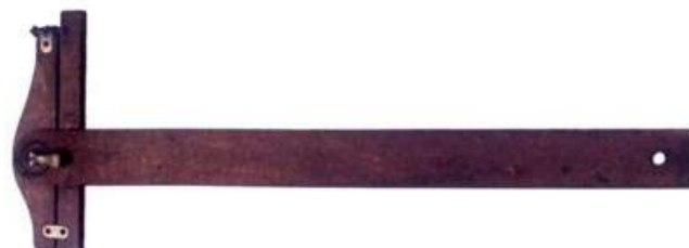
Riga a T in legno ad inclinazione regolabile (circa 1900).
